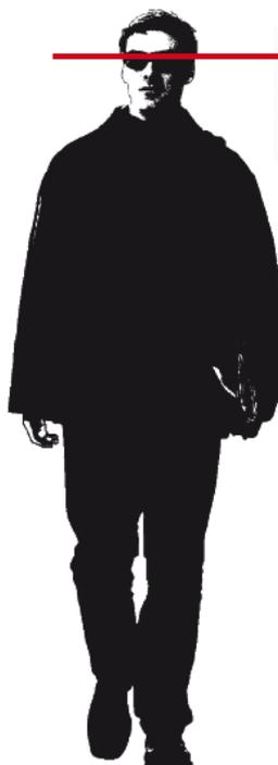
1. Installer le module de contrôle à hauteur d'homme.
