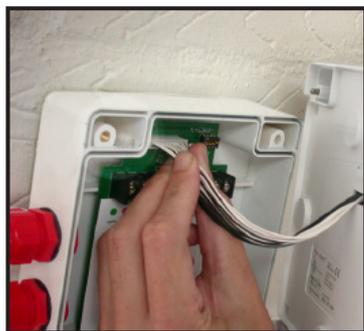
Connecter la tête du détecteur au socle en commençant par brancher le petit câble nappe blanc au socle.
